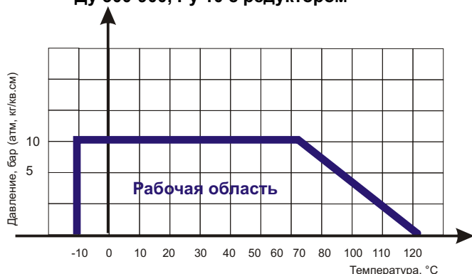
Диаграмма Давление / Температура для задвижки клиновой ABRA-A40-10 с обрезиненным клином и невыедным штоком Ду 300-900, Ру 10 с редуктором
