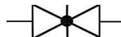
Вариант 4. Знак "Задвижка клиновая или шиберная" Шаровой кран так обозначать неверно, но обозначают так часто.
