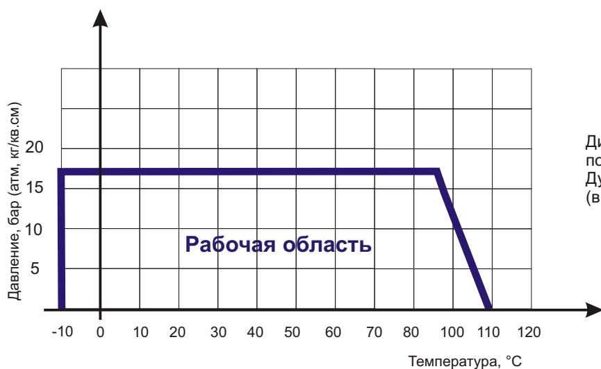
Диаграмма Давление / Температура для затвора поворотного дискового ABRA-BUV-VF826Dxxx Ду40-600, Ру 16
