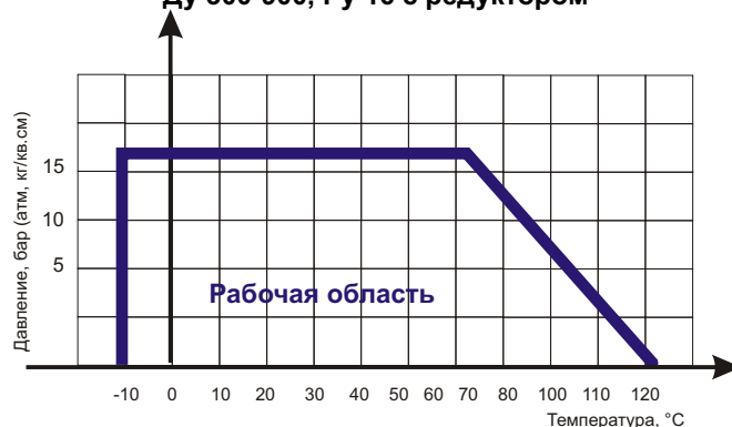
Диаграмма Давление / Температура для задвижки клиновой ABRA-A40-16 с обрезиненным клином и невыедным штоком Ду 300-900, Ру 16 с редуктором
